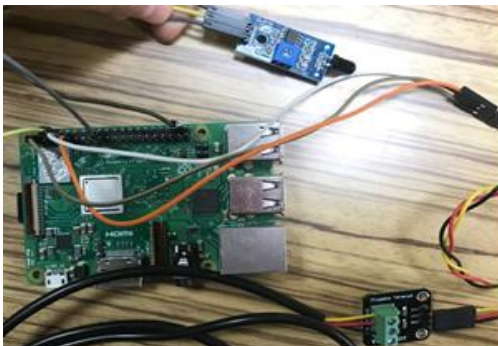
그림 2. Raspberry 를 이용한 화재 감지기
